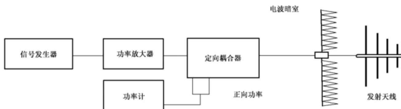
图 D.1 放大器线性度试验布置
