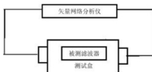
图 A.1 滤波器电性能测试电路框图
